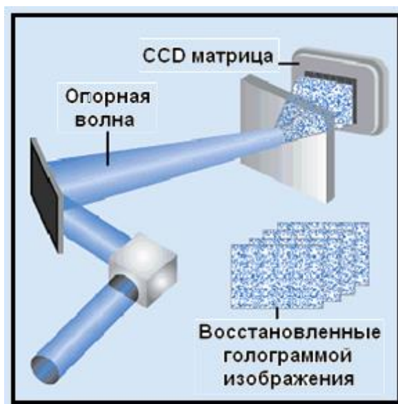
Схема 1. Процесс считывания информации с голографических дисков.
